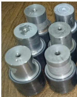
شکل ۵. قطعات بوش و شفت سرهم‌بندی شده پیش از آزمون استخراج
