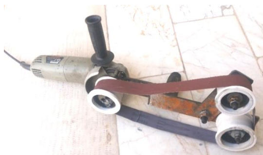
شکل ۱. دستگاه پولیش ساخته شده برای ساخت قطعات دو پهن و سه پهن
