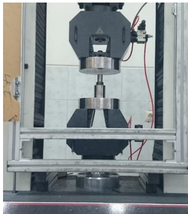
شکل ۶. استخراج شفت از بوش با استفاده از دستگاه آزمون کشش یونیورسال سنتام.
