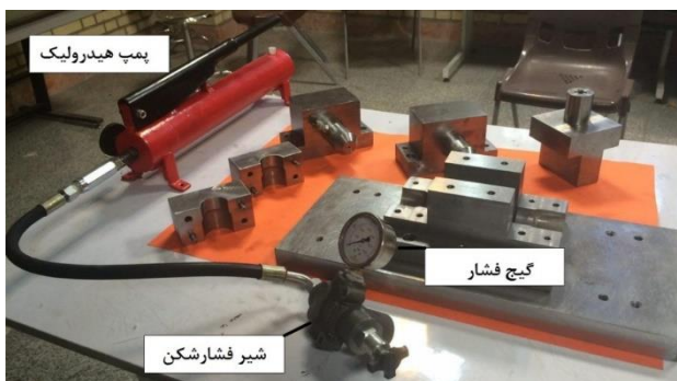
شکل ۵. اجزای مجموعه و مدار هیدرولیکی
