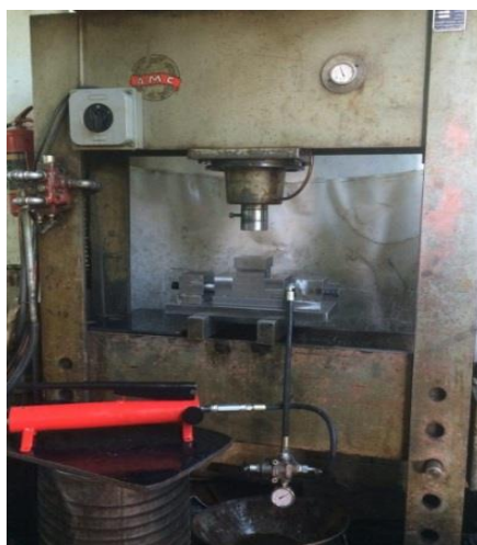
شکل ۶. نحوه قرارگیری مجموعه LPTH زیر دستگاه پرس
