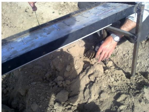
شکل ۱. سازه پین‌متر طراحی شده به منظور اندازه‌گیری تغییرات ارتفاع نقاط مختلف خاک و محاسبه شاخص ناهمواری سطح خاک
