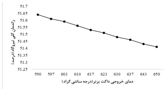
شکل ۱۱. تأثیر دمای دود خروجی داکت برنر بر راندمان بویلر بازیاب
