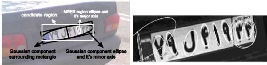
شکل ۳. تشخیص پلاک و حروف آن توسط اعمال گوسین [۱۲].
