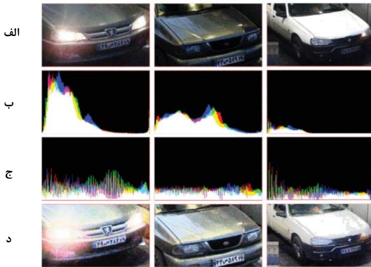
شکل ۵. نمایی از اعمال مسطح‌سازی هیستوگرام به جهت بهبود تصاویر [۱۵]. (الف) تصاویر اصلی، (ب) نمودار هیستوگرام تصویر اصلی، (ج) نمودار هیستوگرام بعد از اعمال الگوریتم مسطح‌سازی و (د) تصاویر بهبودیافته
