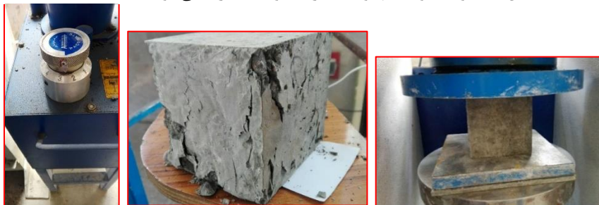
شکل ۷. آزمایش مقاومت فشاری
