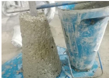
شکل ۴. آزمایش تعیین روانی به روش اسلامپ
