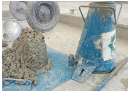
شکل ۴. آزمایش تعیین روانی به روش اسلامپ
