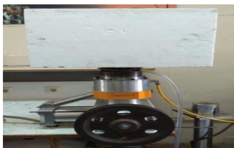
شکل ۱۱. موتور استرلینگ گاما نوع ST500 با عایق جهت تولید سرمایش
