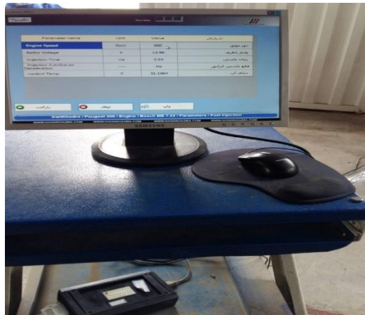
شکل ۲. دستگاه عیب‌یاب خودهای انژکتوری (دیاگ)
