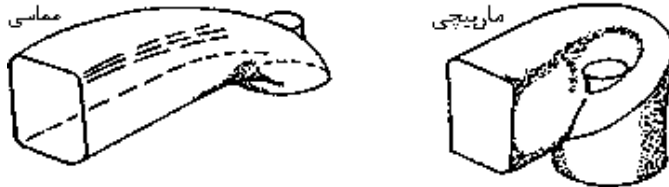
شکل ۲. روش‌های اساسی برای به وجود آوردن جریان گردابه [۱۵]
