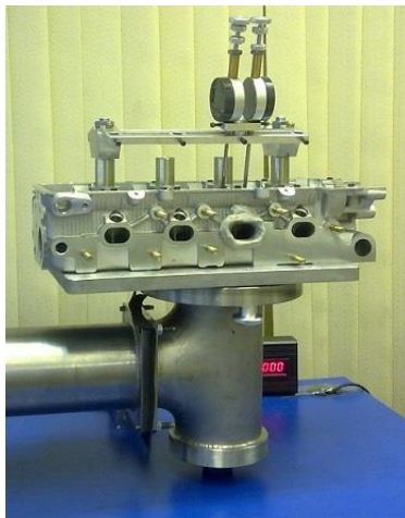
شکل ۹. نصب سرسیلندر روی میز جریان و آزمایش جریان
