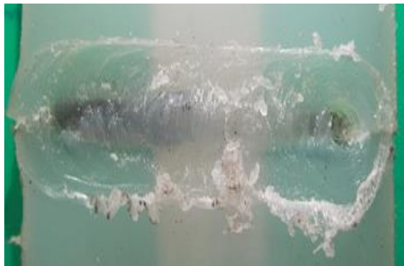
شکل ۱۰. جوش ایجاد شده توسط ابزار مخروطی با شولدر صاف
