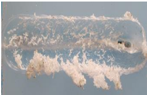
شکل ۱۴. پلیسه‌های ایجاد شده در اثر زاویه کَلگی ۳ درجه
